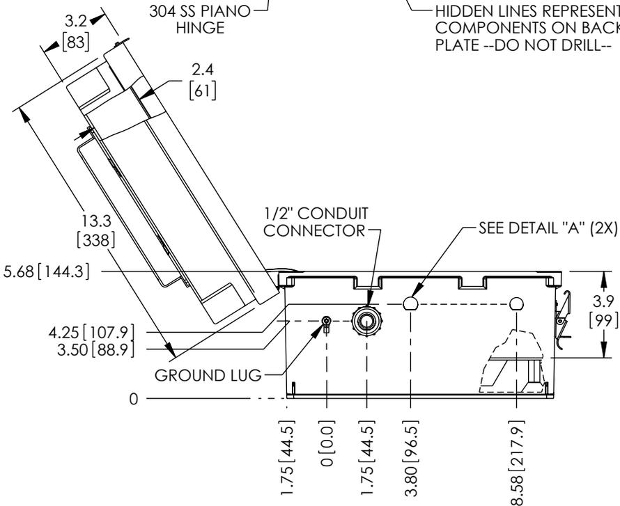
HIDDEN LINES REPRESENT COMPONENTS ON BACK OF PLATE --DO NOT DRILL--
